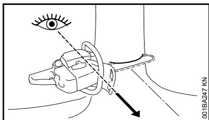
Beim Anlegen des Fallkerbes die Motorsäge so ausrichten, dass der Fallkerb im rechten Winkel zur Fällrichtung liegt.
