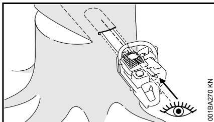
Wenn möglich, Stechleiste verwenden. Die Stechleiste und die Ober- bzw. Unterseite der Führungsschiene sind parallel.
