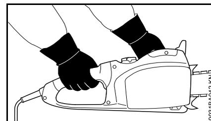
Motorsäge immer **mit beiden Händen festhalten**: Rechte Hand am hinteren Handgriff – auch bei Linkshändern. Zur sicheren Führung Bedienungsgriff und Handgriff mit den Daumen fest umfassen.
