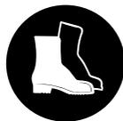
**Geeignetes Schuhwerk** tragen – mit Schnittschutz, griffiger Sohle und Stahlkappe.
