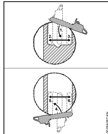
Diesen Fällschnitt ausführen, wenn der Stammdurchmesser größer als die Schnittlänge der Motorsäge ist.
