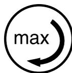
Die zulässige Drehzahl der Schleifscheibe muss gleich hoch oder höher sein als die maximale Drehzahl der Welle des Schleifgerätes! – siehe "Technische Daten".
